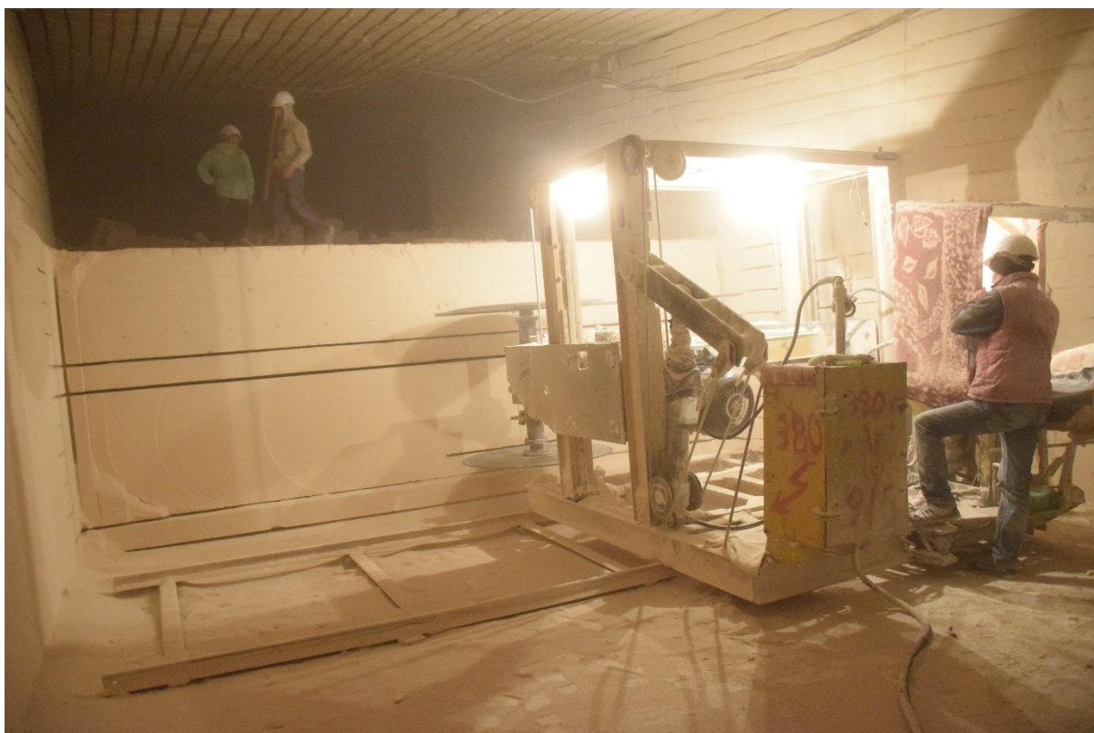
Foto 9 Tăierea calcarului la ÎS Mina din Brănești
